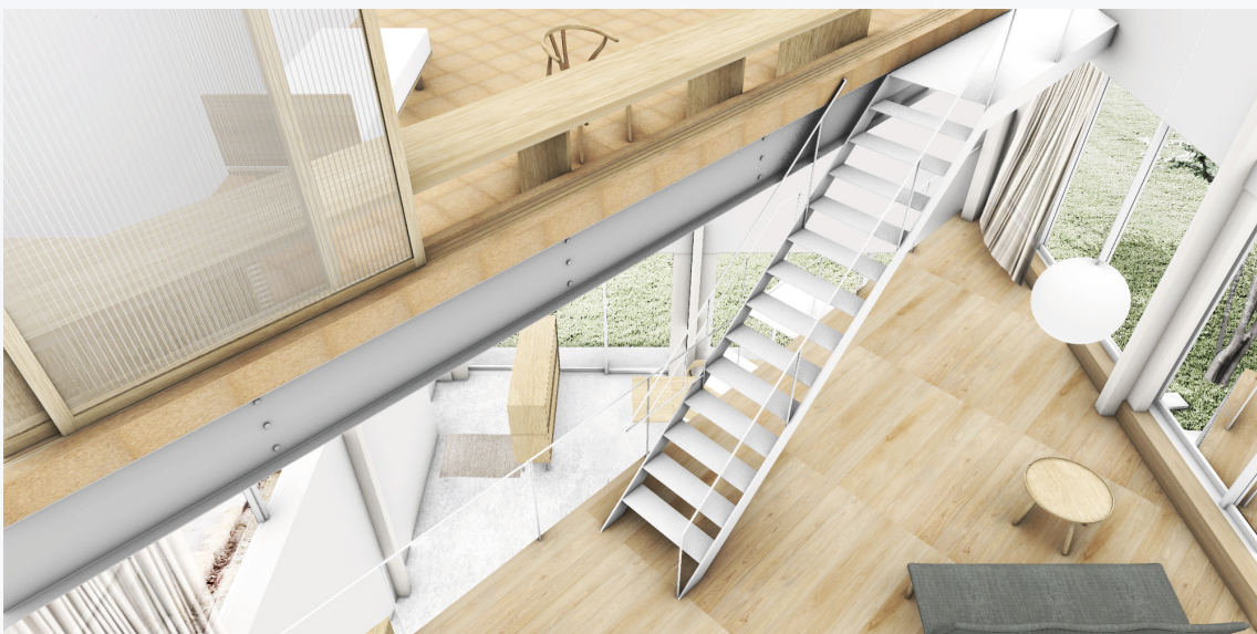
見下ろし：各層で床仕上が異なる 2 階は逆梁で JBF が立上りとなり、建具レールを兼ねる
